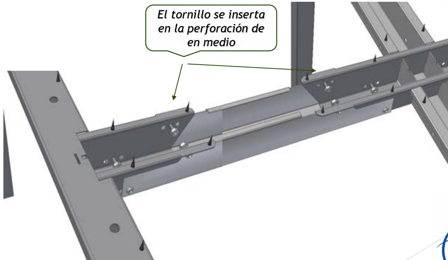
El tornillo se inserta en la perforación de en medio
