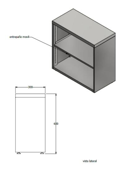
14M13- ESTANTERIA METALICA DIMENSIONES 60 ANCHO X 60 ALTURA X 30 FONDO, SIN PUERTA Y CON LATERALES EN COLD ROLLED , 2 NIVELES UTILES, CON ESPALDAR Y ENTREPAÑOS REMOVIBLES , PINTURA COLOR BLANCO \$ 456,081 CANT 14
