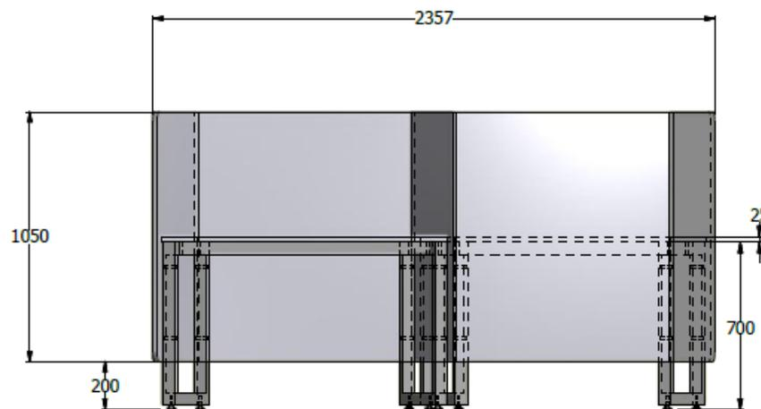
MODULO DOBLE ESP. (C/U 1,25X1,20X0,60) SUPERFICIE LDAP25mm - PANTALLAS FRONTALES Y LATERALES EN TELA- NO INCLUYE CONDUCTIVIDAD
