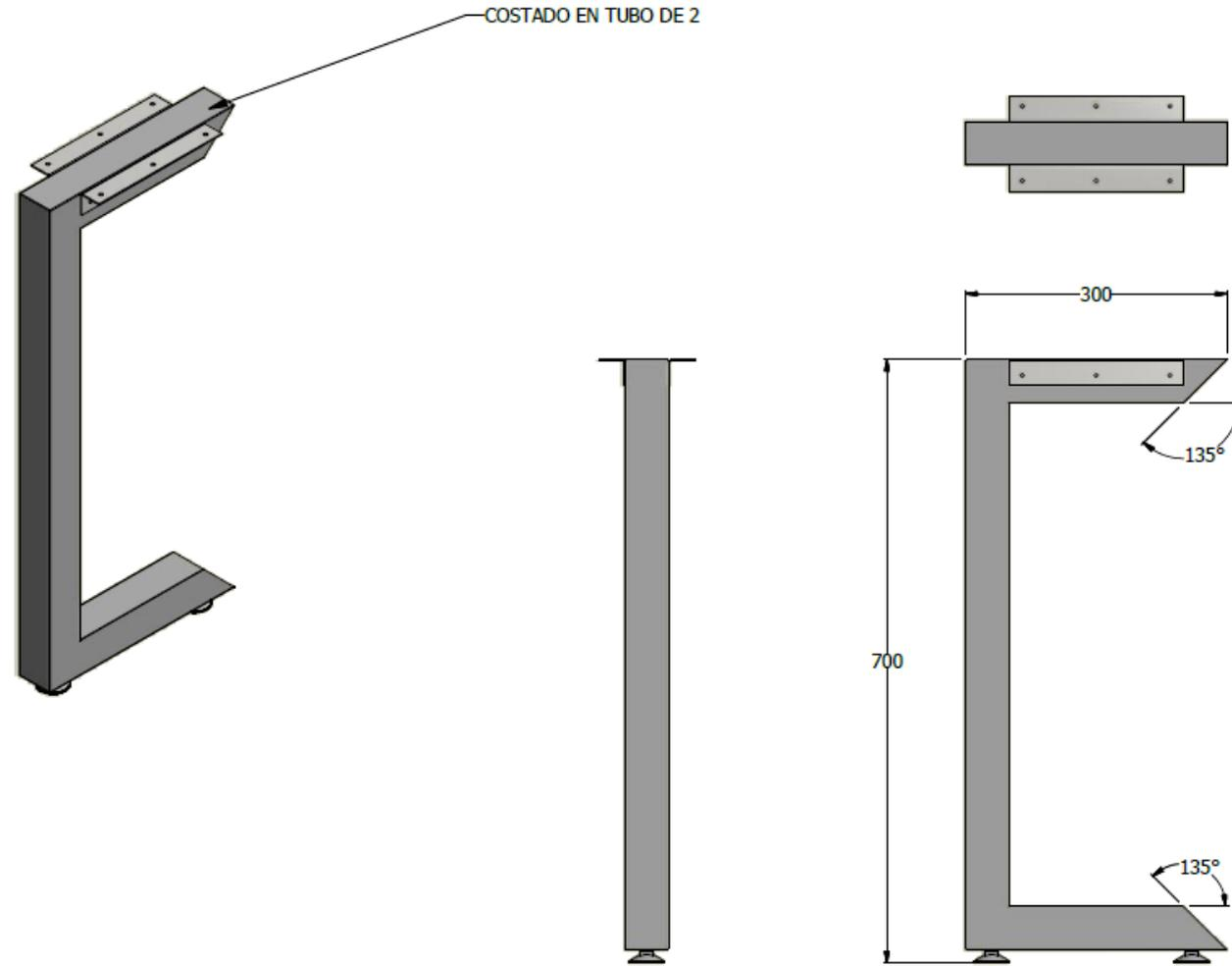
costado esp. 0,71X0,30 tubo 2 " en forma de C, con medida especial, según detalle adjunto
