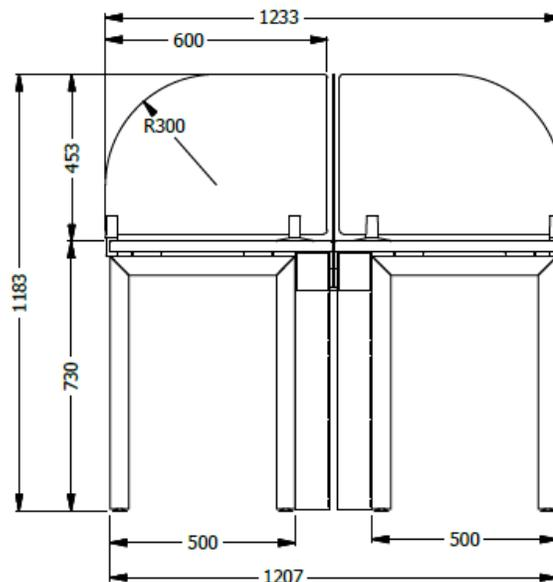
PUESTO CALL CENTER DOBLE (2PUESTOS ENFRENTADOS) ESP. 1,00- COMPUESTO DE SUPERFICIE PASACABLES LDAP - COSTADO EN C.R - NO INCLUYE CAJON AEREO CUERPO C.R FRENTE ACRILICO - PANTALLA LATERAL VD LAM.3+3 . PANTALLA FRONTAL EN VD AZUL - CANALETA DE CABLEADO
