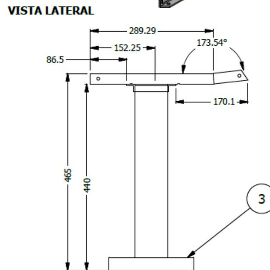
PEDESTAL ANCLADO A PISO PARA SILLA ORION 8 CON PLAFON SEGÚN PROTOTIPO ENVIADO (OR-73699-037) CANT. 304
