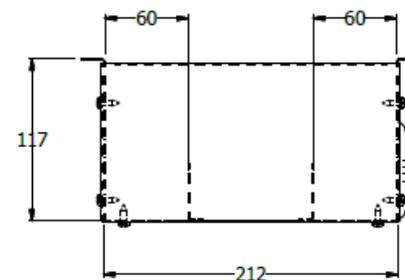
DUCTO BANDEJA DOBLE TERMINAL ESP. 1,60 AJUSTADO A SUPERFICIE 0,80 - 1 JUEGO DE TOMAS POR CADA LADO
