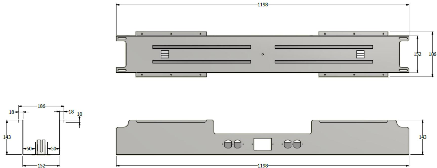
BANDEJA DE CABLEADO EQ. X 1.200 m. DOBLE CON SOPORTE PARA PANTALLA 3+3
