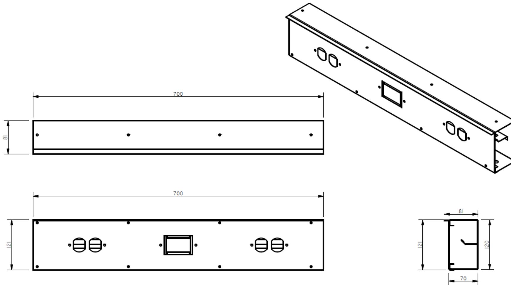
CANALETA CONDUCTORA SENCILLA A SUPERFICIE DE 12 X 7 CM LONGITUD 0,70 PINTURA ELECTROSTATICA
