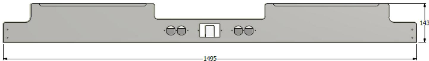
BANDEJA DOBLE PARA SUPERFICIE ESP. 1,50 CON SOPORTES PARA PANTALLA.
