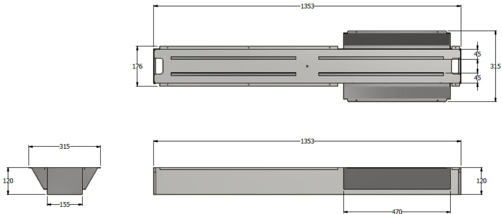
CANALETA DE CABLEADO ESP.METALICA PARA GROMET QUICK, LARGO 1,28 cm SIN TROQUELES PERO CON LAS 2 TAPAS TERMINALES
