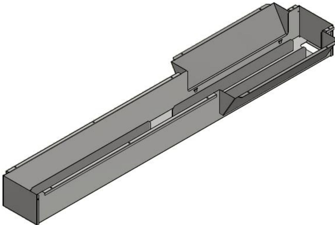
CANALETA DE CABLEADO ESP.METALICA PARA GROMET QUICK, LARGO 1,28 cm SIN TROQUELES PERO CON LAS 2 TAPAS TERMINALES
