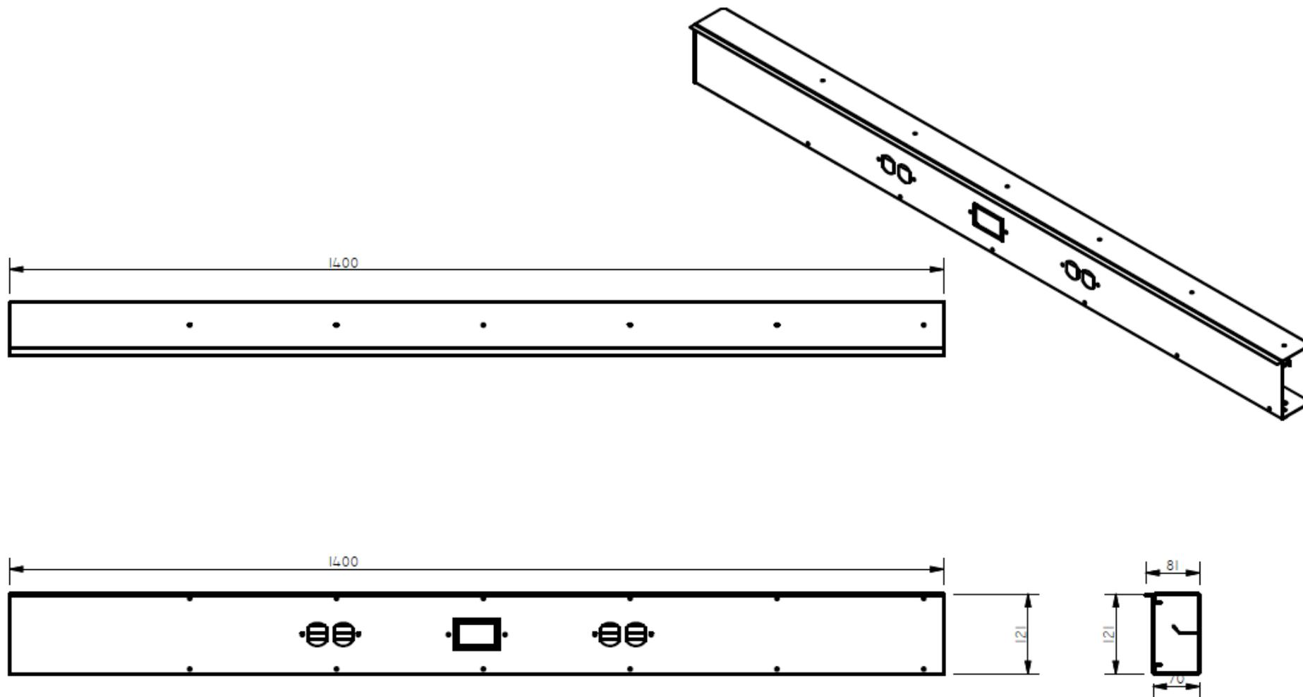
CANALETA CONDUCTORA SENCILLA A SUPERFICIE DE 12 X 7 CM LONGITUD 1,4 PINTURA ELECTROSTATICA
