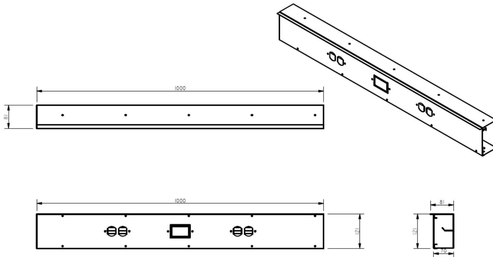
CANALETA CONDUCTORA SENCILLA A SUPERFICIE DE 12 X 7 CM LONGITUD 1,0 PINTURA ELECTROSTATICA
