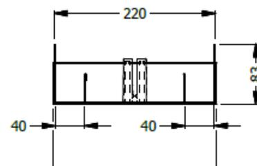
DUCTO DOBLE EURO ESP. TERMINAL PARA SUPERFICIE DE 1,00
