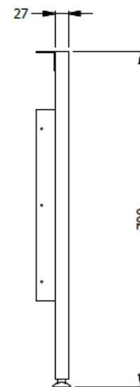
LATERAL BENCH ESP. 0,70x1,50 LDAP 25MM PARA COLOCAR DEBAJO DE SUPERFICIE DEBE INCLUIR NIVELADORES, SOPORTES Y AMARRES C.R
