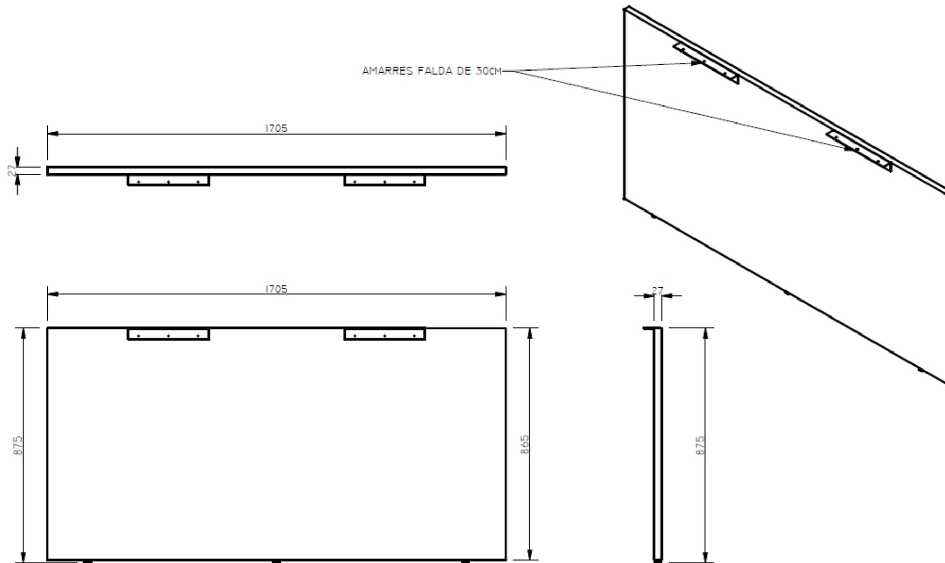
LATERAL BENCH ESP. 0,875X1,705 EN 25MM DE ALTURA EN LDAP CON AMARRE FALDA
