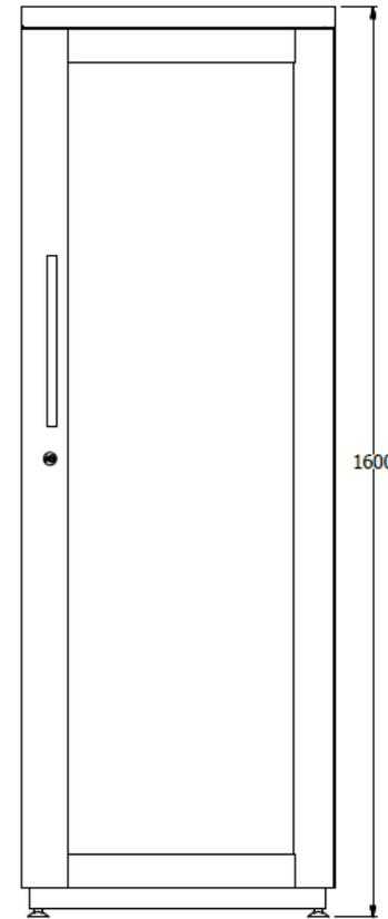
Mueble Metálico esp. 1,60X0,55X0,25 puerta acriloco perforaciones laterales para ventilación / placa interior con perforaciones para graduar placas metálicas donde van los tubos que soportan los endoscopios.con cierre de seguridad
