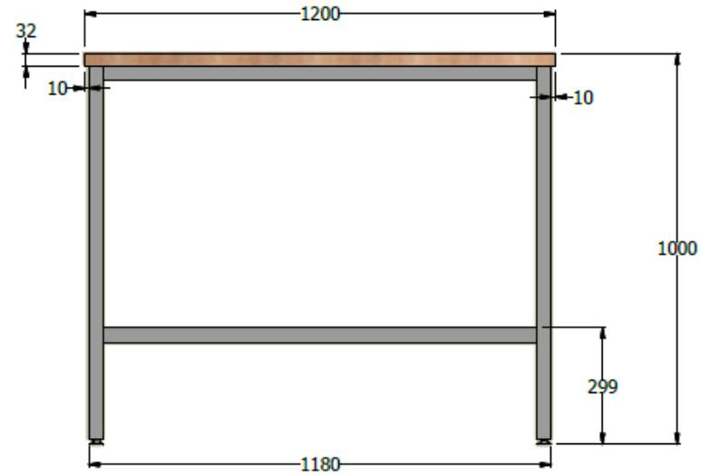
BARRA EN ACABADO FORMICA DE 1.20 X 50 X 90 DE ALTO , ESPESOR DE LA SUPERFICIE 30mm
