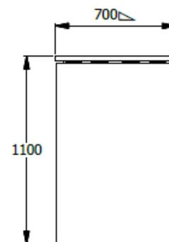
MESA ALTA ESP. 1,10X3,35X0,70 CON CONECTIVIDAD COSTADOS LATERALES EQUILA CON TAPAS BASE CENTRAL MJ EQ CON VIGAS Y FALDA - SUPERFICIE EN LDAP - TAPAS DE BASES EN LDAP
