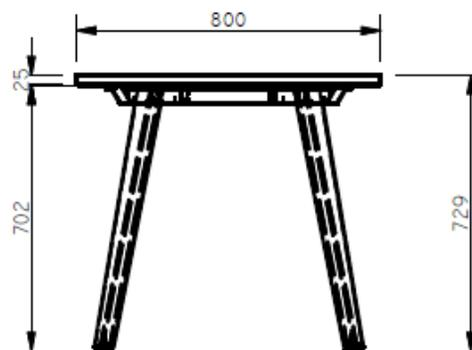
ESTRUCTURA EURO PARA SUPERFICIE DE ESP. 1.70 X 80 EN 25 MM CON VIGAS Y COSTADOS
