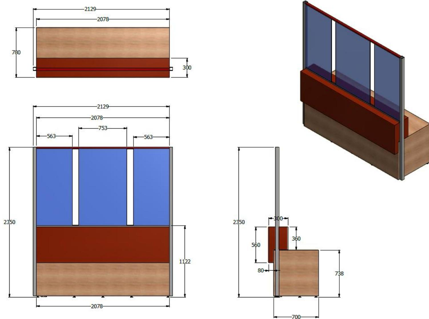
MODULO RECEPCION 2,35X2,04X0,70 EN LDAP Y VIDRIO TEMPLADO 10mm MODULADO EN TRES PARTES - PERFIL CUADRADO A CADA EXTREMO
