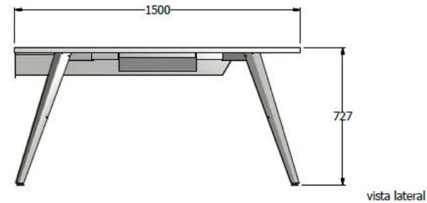
MESA DE JUNTAS DE LINEA DE 1,50X1,50, CON CONECTIVIDAD (la salida del cableado va desde el muro por debajo de la superficie)no del piso, asi que no debe subir por la pata
