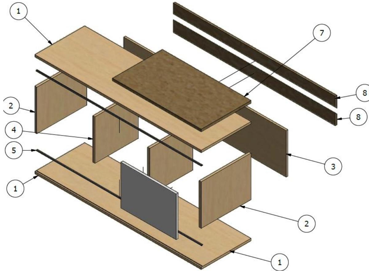
MUEBLE CREDENZA FLOTANTE 0,40x1,50x0,45 LDAP (IGUAL AL ENTREGADO EN SPACES EL NOGAL) Estructura elaborada en tablex RH de 15mm forrado en madera Urapan. Realce en mármol puerta corrediza formica 40X150X45
