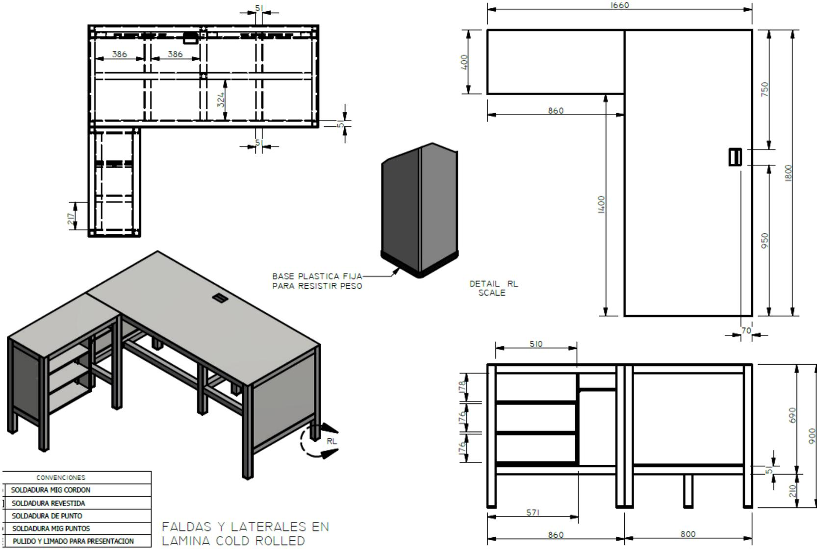
MESA ESP. 0,95X1,80X1,66 BASE FABRICADA EN ESTRUCTURA CUADRADA 40X1,5 mm CON NIVELADOR METALICO. SUPERFICIE EN LAMINA CR CAL 18 ACABADO PINTURA ELECTROESTATICA. PANEL POSTERIOR EN FORMICA AMARILLA- PESO A SOPORTAR 100 KILOS -SISTEMA DE CONDUCCION H95- LA
