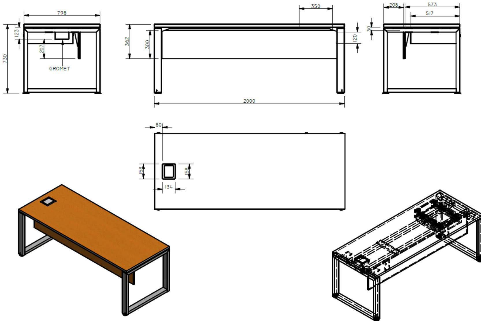
PUESTO TRABAJO GERENCIA 1:SUP 0,80 X 2,0 30MM,2 COSTADO EQUILATERO H 0,73 X 0,80 , VIGA ANTI PANDEO , GROMET SOCK PUSH, BAJANTE A PISO PARA GROMET SOCK.FALDA PARA SUPERFICIE 2,00 H 0,30 HERRAJE Z.CAJON COLGANTE LDAP F -035 H 0,12 CERRADURA
