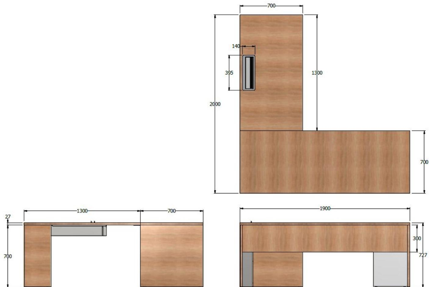
PTO GTE SUP PPAL 1,90x0,70 CON UN COSTADO EQUILA CON TAPAS Y AL REMATE UN LATERAL RETORNO 1,30x0,70 CON GROMET Y TOLVA CON COSTADO CON TAPAS CON CAJNERA FTE 38 EN LDAP EN EL REMATE DE LA SUP PPAL CON GROMMET FALDA TODO EN LDAP
