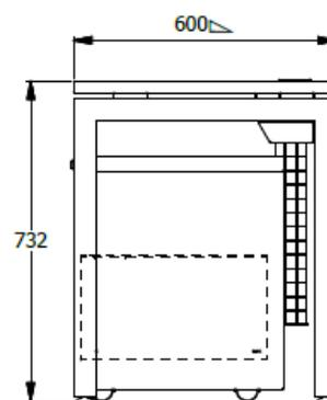
ESTACION DE TRABAJO N.2 ESP. 0,73X1,50X0,60 - SUPERFICIE LDAP 25MM UNICOLOR - BASES EN TUBO 2" C.R - FALDA EN LDAP - CAJONERA FRENTE FORMICA
