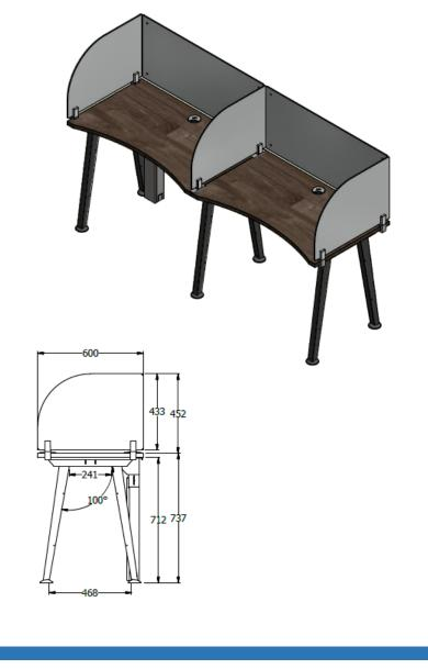
ISLA 2 PUESTOS CENTRAL: 2 SUP CURVAS LDAP 25MM, 3 COSTADOS 3" ESP H 0,71 X 0,60 PINTURA ELECTROSTATICA, 2 VIGAS REFUERZO,2 CANALETAS, 2 PASACABLE PLSATICO, 3 PANTALLAS INTERMEDIAS CURVAS Y 3 FRONTALES 3+3 BLANCO HIELO,1 BAJANTE CABLEADO 0,80 X 0,80
