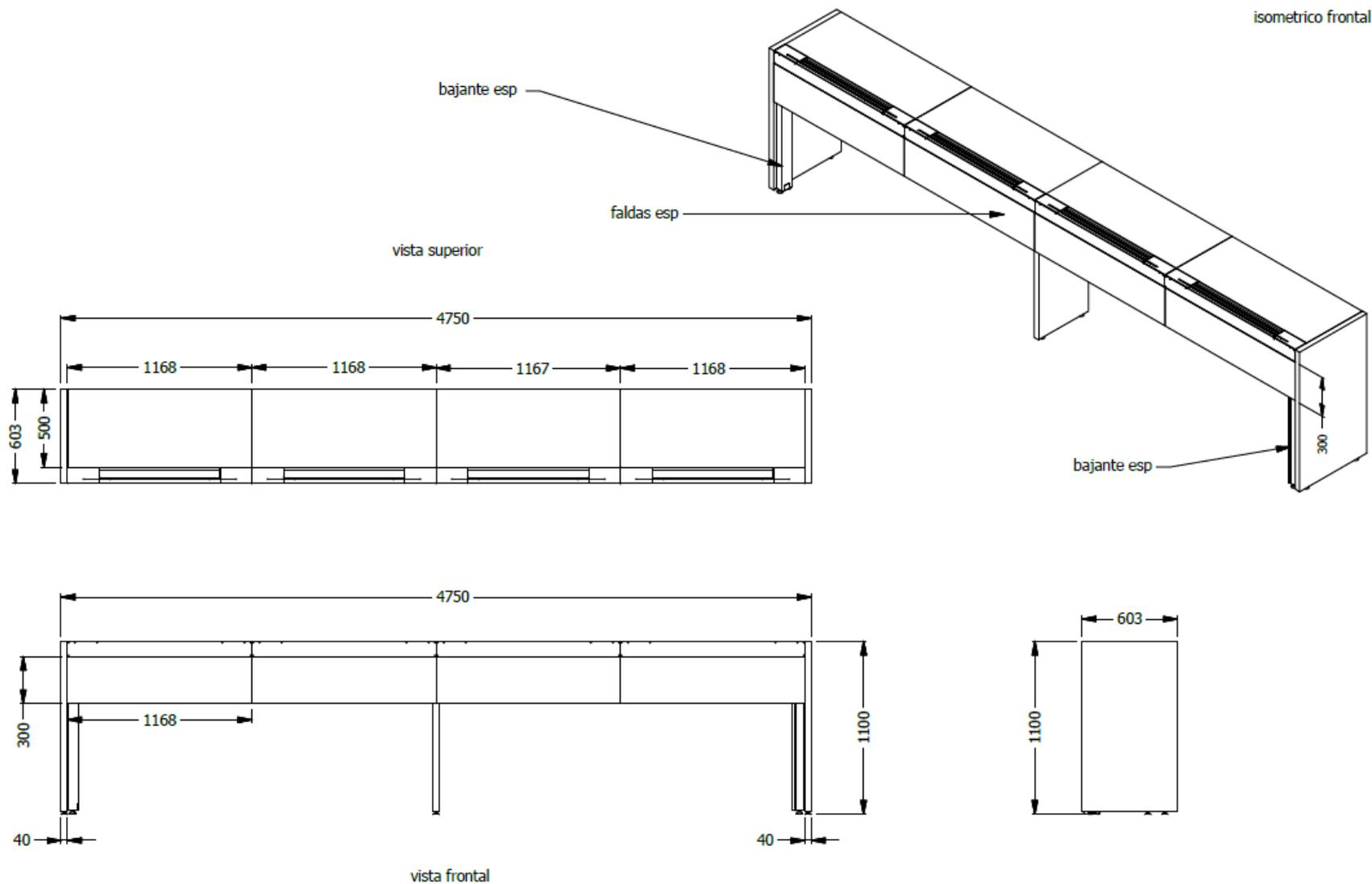
BARRA SENCILLA MODULAR ESP. 4,96X0,60 CON SUPERFICIE Y LATERALES ENTAMBORADO LDAP Y FALDA EN MELAMINA, CON DUCTO PARA CONDUCCION
