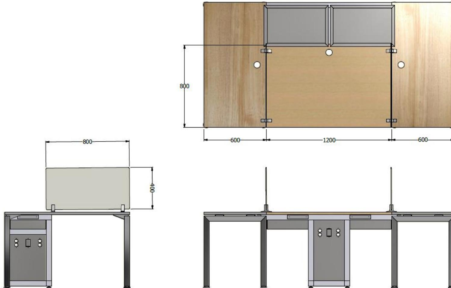
ISLA 3 PUESTOS DE TRABAJO ESP. 1,10X2,40X1,20 LDAP25mm (SUPERF.1,20X0,60)MACETA CENTRAL PARA PLANTA - PANTALLA HIELO - BANDEJA CABLEADO - SUBIDA CABLEADO CENTRAL - PASACABLES
