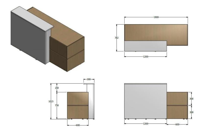
RECEPCION TIPO 2, ESP. CON EL MOSTRADOR DE LADO IZQ. .SE ADJUNTA DETALLE .PASACABLE DE UN LADO - DE LINEA
