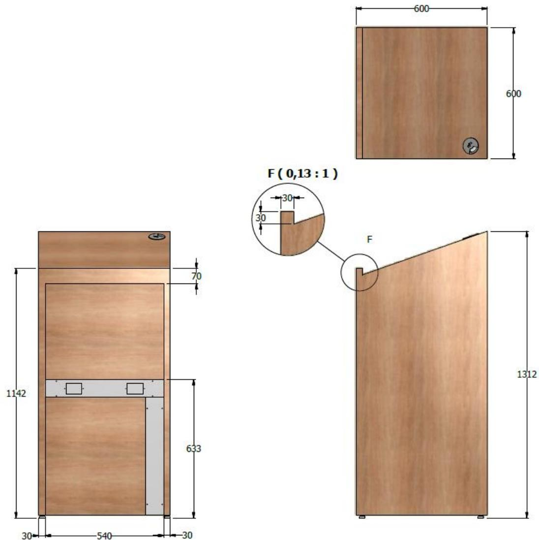
ATRIL ESP. 1,30x0,60x0,60 PARA SALA DE AUDIENCIAS EN AGLOMERADO DE 30 MM. CON ACABADO EN FORMICA Y CANTO PLANO TERMOFUNDIDO
