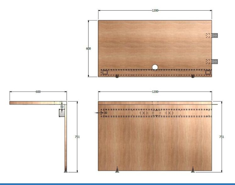
SUPERFICIE Y COSTADO LATERAL A PISO 0,755x1,02 LDAP, SUPERFICIE 30mm, CON PASACALE Y NIVELADORES - LATERAL 19mm - SEGÚN DISEÑO ADJUNTO
