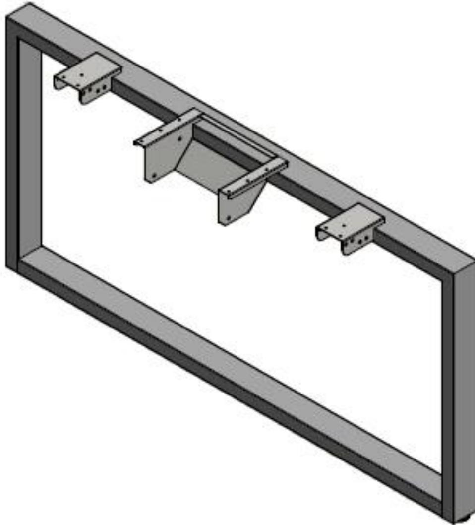
COSTADO EQUILATERO PIE DE AMIGO SENCILLO 0.71 X 1.41 APROX (PARA SOPORTAR DOS SUPERFICIES DE 70 CMS. ENFRENTADAS MAS LA PANTALLA QUE VA SOBRE EL DUCTO PLUS) TERMINAL PARA DUCTO PLUS CON SOPORTES MAS LARGOS
