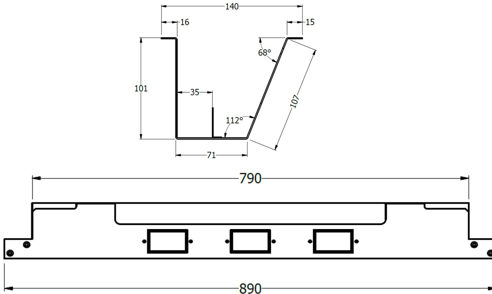
BANDEJA DE CABLEADO ESP. 0,90 PARA COSTADO DE 2" Y PARA GROMET SUPERIOR TIPO QUIK
