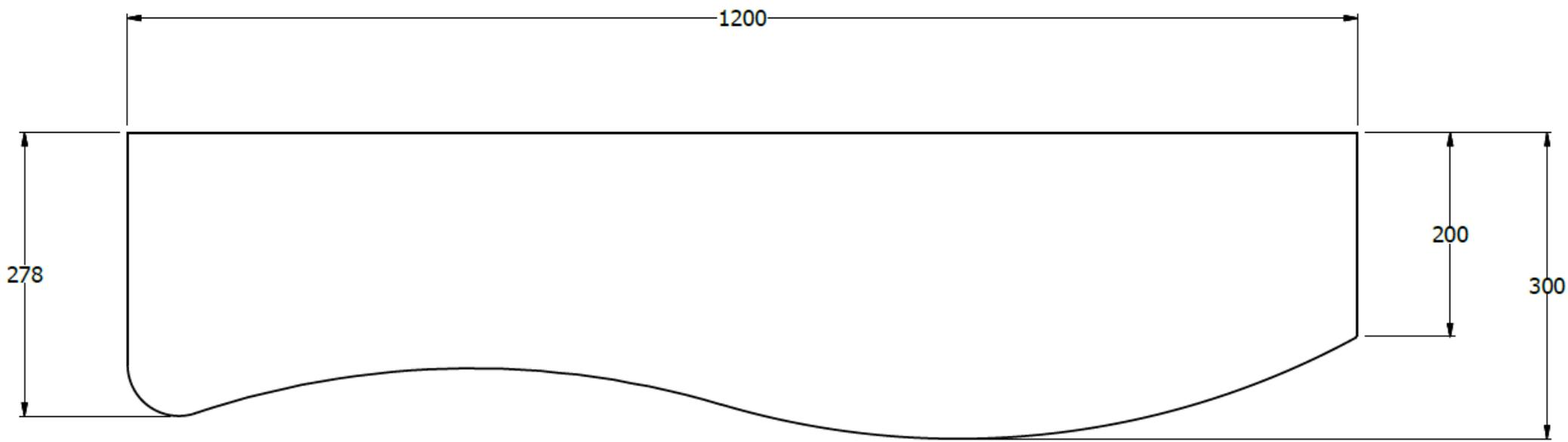
Modulo insonorización en lamina ESPUMA de 2 pulgadas de espesor tapizado en tela vinilo, 1.20 x 20cms . dos pernos en los bordes superiores colgar las guayas al techo largo 1,00.
