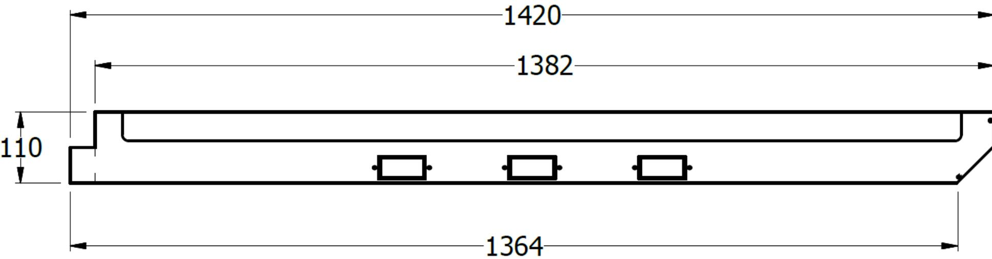
DUCTO SENCILLO PLUS TERMINAL PARA SUPERFICIE DE ESP. 1.50.
