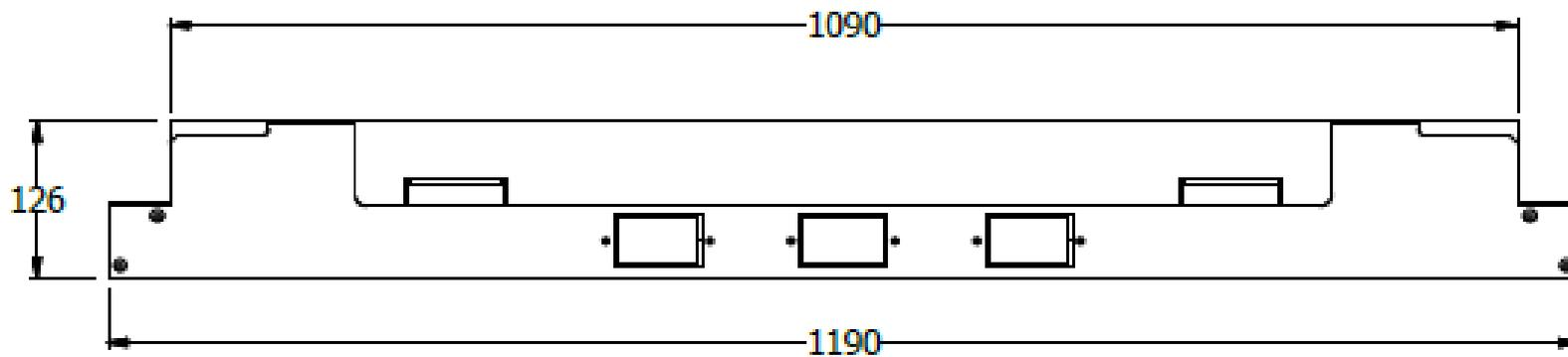
BANDEJA DE CABLEADO ESP. 1,20 PARA COSTADO DE 2" Y PARA GROMET SUPERIOR TIPO QUIK
