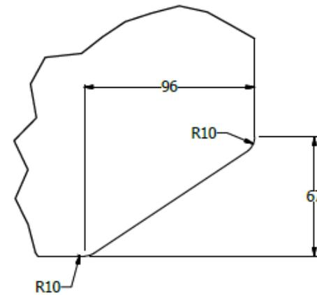
PANTALLA TERMINAL EN VIDRIO LAMINADO HIELO 3 + 3 PARA PUESTOS DOBLES OPERATIVOS PLUS DE 1.500 (523x1025 - DESCONTAR ANCHO DE CAJON AEREO). SOBRESALE 45 CMS. RESPECTO A LA SUPERFICIE.
