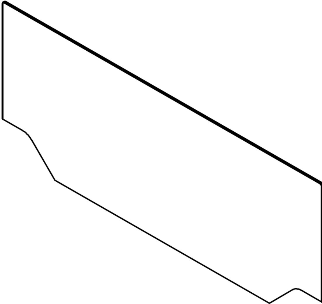
PANTALLA VIDRIO LAM. 3+3 PARA DUCTO DOBLE DE 1,20x0,38 DE ALTURA SOBRE SUPERFICIE CON CAJA
