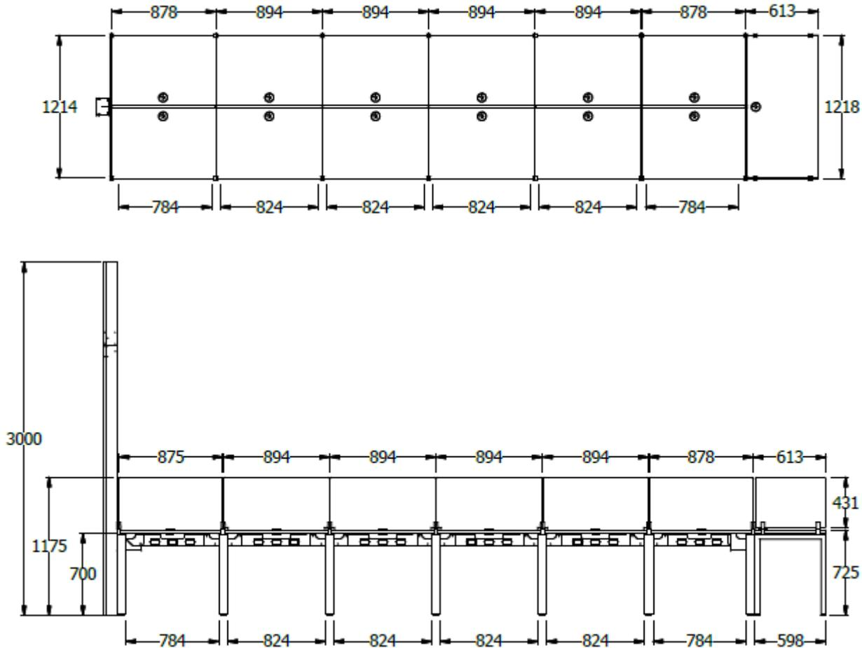
ISLA DE 13 PUESTOS ESTRUCT PARA 12 SUPERF DE 90X60, 1 DE 120X60, SIN CAJONERAS, CON BAJANTE DE PISO A TECHO, CON 3 PANTALLAS ACUSTICA FRONT EN PROQUINAL DE 180 DE ANCHO, CON 4 PANTALLA LATER EN HIELO 3+3 120 DE ANCHO , CON 6 PANTAL DE 60 DE ANC HIELO
